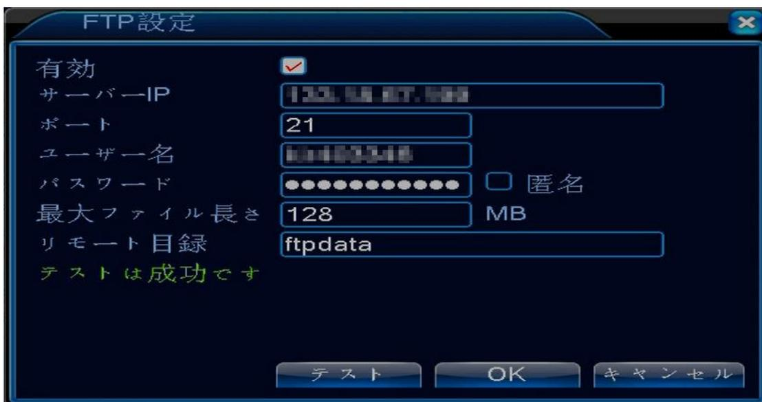
アラーム設定で FTP アップロードにチェックマークを入れ、OK をクリックして設定完了です。
