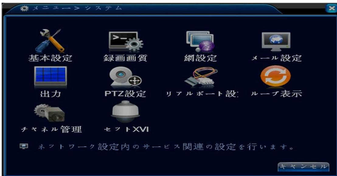
メール設定の中の DDNS をダブルクリック、または右端のアイコンをクリックします。
