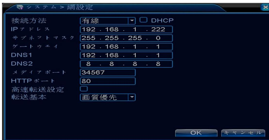
IP アドレスから HTTP ポートまでの入力が完了し、OK をクリックしたらメディアポート、HTTP ポートに入力されている番号のポートを開放します。
